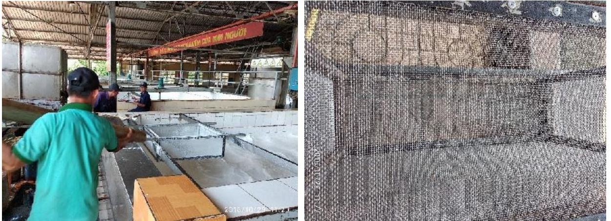
Hình 3. 16. Xử lý nguyên liệu latex đầu vào bằng rây lọc 40mesh tại hồ tiếp nhận
