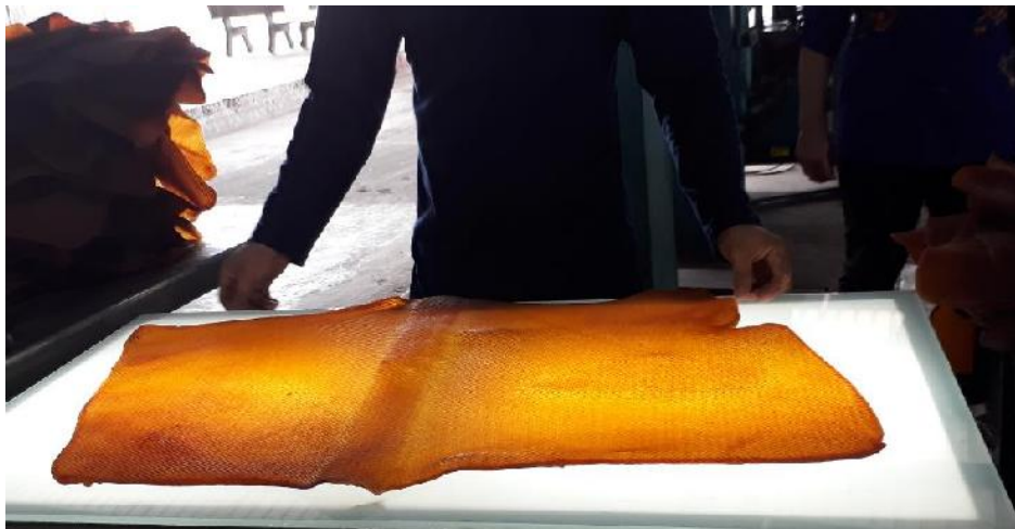
Hình 3. 33. Soi đèn và đánh giá bằng mắt để phân hạng cao su tờ xông khói RSS
